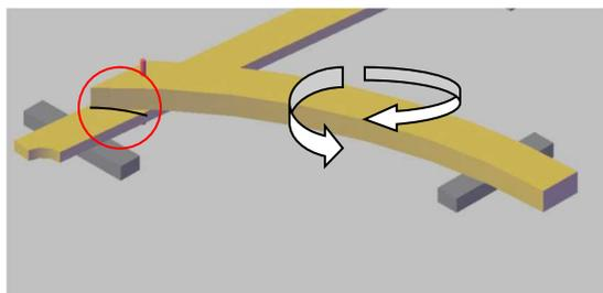
Prendete il pilastro curvo anteriore segnato con eguale lettera/numero e centrate i fori inserite la barra filettata nel foro ruotate il pilastro fino a quando questo non si allinea con i segni presenti sulla trave superiore.
